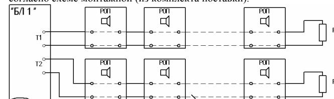
3.5.7. БЛ поставляются с замкнутыми между собой клеммами «12 V-» и «K-» также и «+12 V» и «K+». Снять перемычки с контактов, если требуется подключение постоянно светящихся световых оповещателей.
